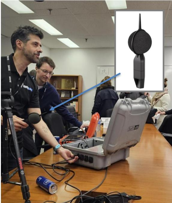
Dans la boîte de la station de mesure se trouve une carte d'acquisition connectée au sonomètre. Le microphone est équipé d'une bonnette anti-vent qui le protège également des intempéries et est munie d'un pic anti-oiseaux.
